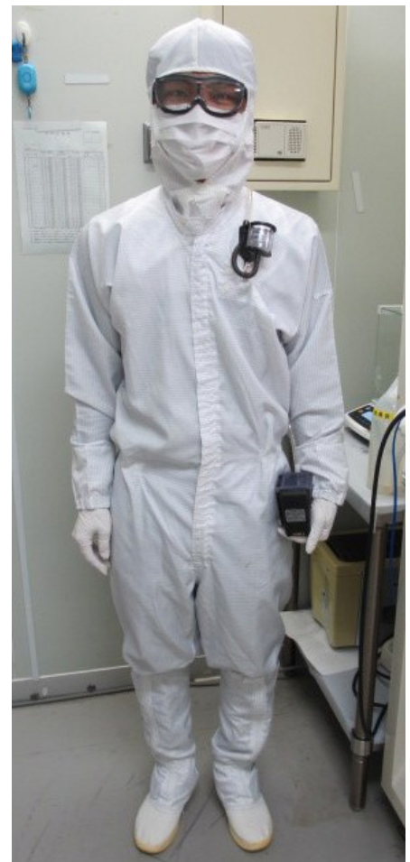
個人曝露調査用の パーソナルサンプラー装着例
