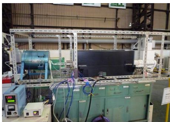
図2 水蒸気酸化試験の装置外観
