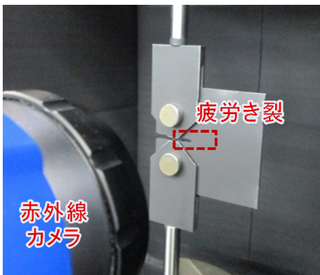
疲労試験機によるき裂検出試験
