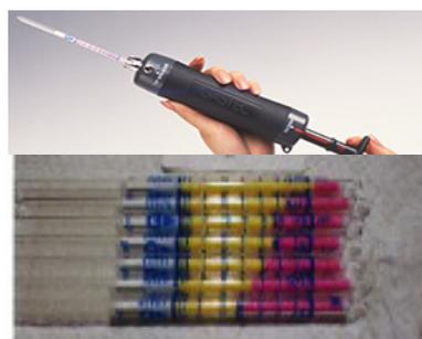
アンモニア、アセトアルデヒド、酢酸の3種類のガス濃度を測定
