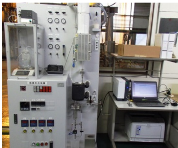
図1 ガス流通式 触媒評価試験装置例
