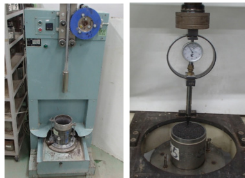
CBR試験 JIS A 1211 締固め試験・コーン貫入試験状況
