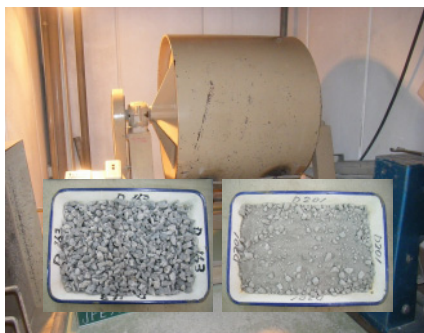
粗骨材のすりへり試験 JIS A 1121 試料粉碎前後
