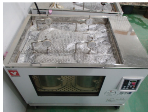
水浸膨張率試験 JIS A 5015 付属書B 80℃膨張率測定状況
