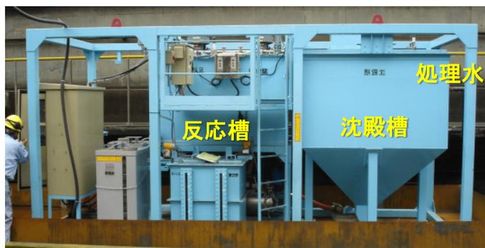
硝化・脱窒の連続ベンチ試験装置 (反応槽1.4m<sup>2</sup>、沈殿槽3m<sup>3</sup>)
