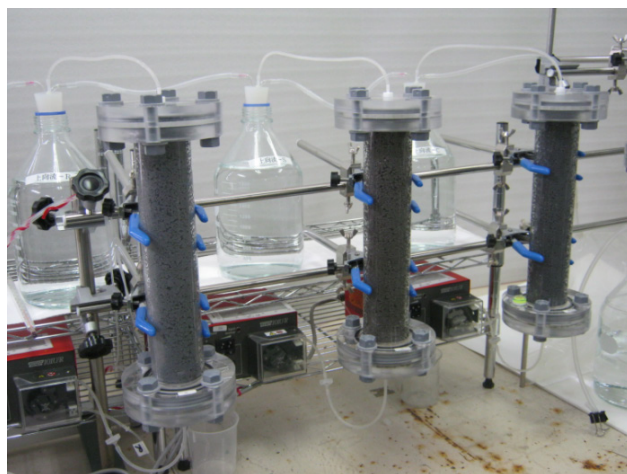
スラグ浸出水処理試験装置 (ラボスケール)
