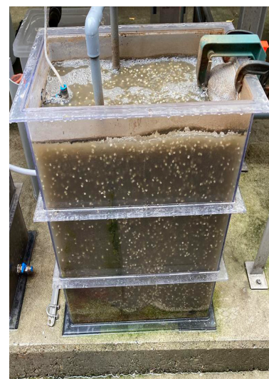
写真2 担体処理実証試験水槽
