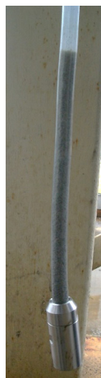
写真1 ゾーンメーター採取の沈降汚泥
