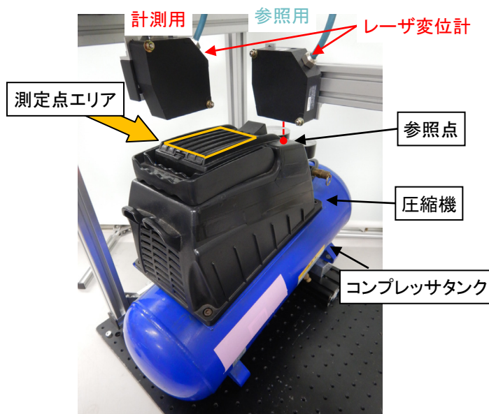
エアーコンプレッサーの圧縮機軽量カバー上面の測定例
