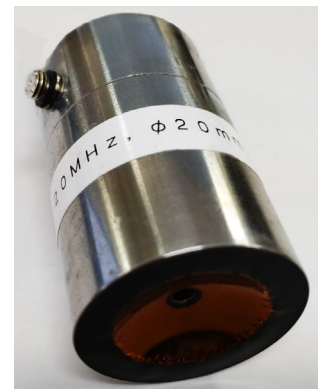
写真1. 漏洩表面波プローブ外観
