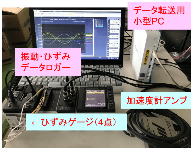
図1 振動・ひずみの連続自動計測装置 測定部
