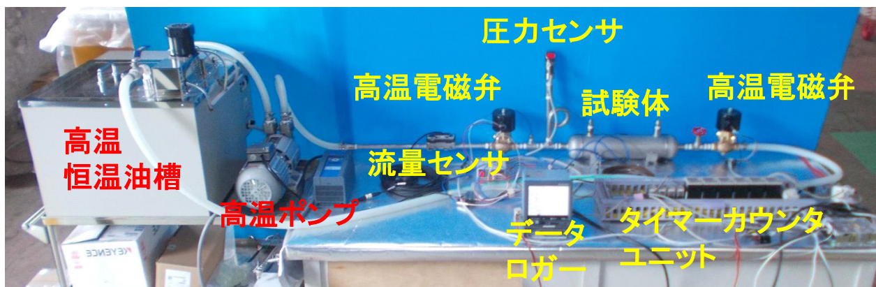
写真1 高温インパルス試験装置の外観
