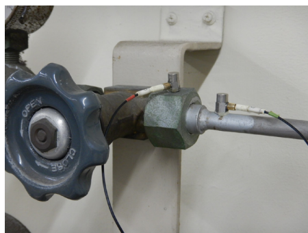
加速度センサによる振動計測
