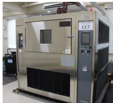
CCT装置 (内槽寸法: W1200 × D900 × H1100)
