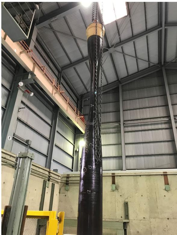
写真 試験により圧潰(コラプス)した鋼管の外観
