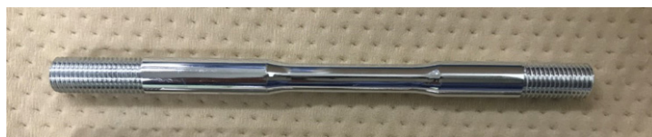
水素脆化試験用試験片
