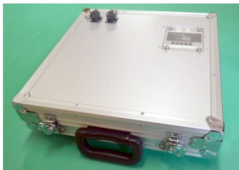
低温域用光ファイバー温度計の外観
