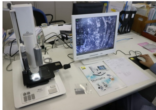
ハンディカメラ部を電動スタンドに取り付け撮影
