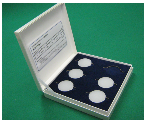
図1. プラスチック中塩素分析用標準試料
