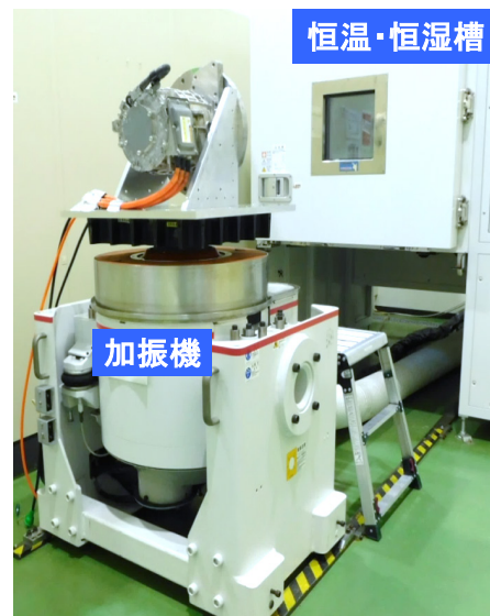
回転中モータ複合環境振動試験装置外観
