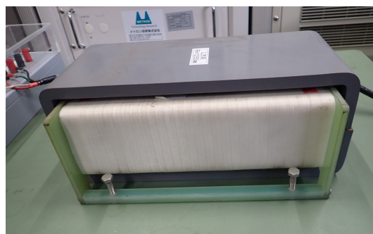
曲げSST R1250mm(長手方向)
