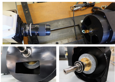
高速度カメラによるモータ試験風景
