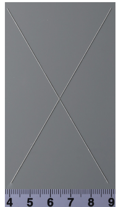
写真3 電着塗装板のSST後の外観
