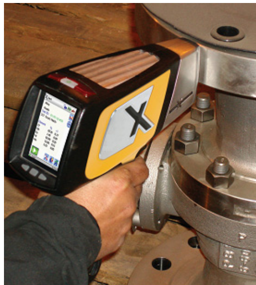
図2. PMI試験の実施例
