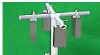
クーポン試験片による腐食減量試験
