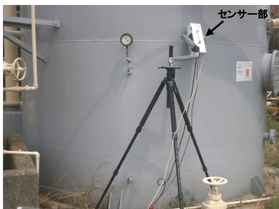
写真1 溶接部の残留応力測定(塗装剥離後)
