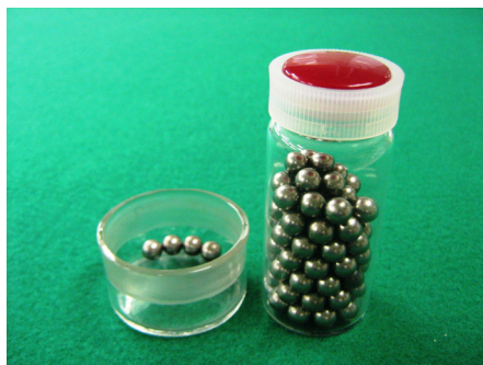
鉄鋼中極微量水素分析用標準試料
