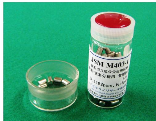
図1. 高濃度酸素標準試料(100個/瓶)
