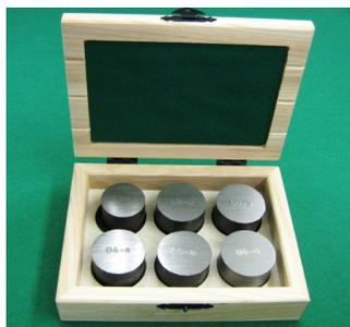
図1 鉄鋼中高濃度酸素標準試料
