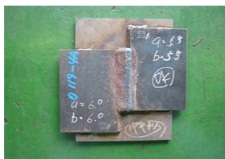
隅肉溶接試験体
