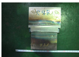
代替エンドタブ溶接試験体
