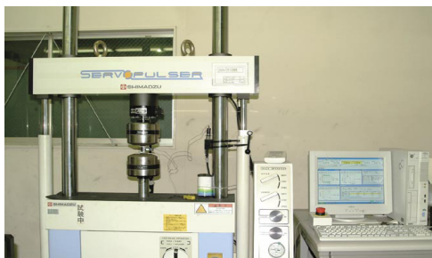
【機械的性質】 万能材料試験機
