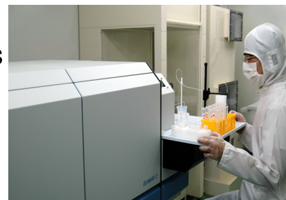
【化学分析】 二重収束型ICP-MS
