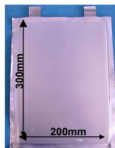
図6 ラミネートセルの外観
