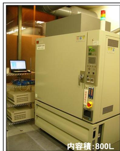
図2 安全機構付恒温槽
