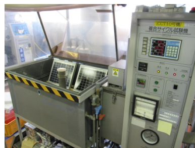
写真 太陽電池モジュールの複合サイクル腐食試験機への取り付け例
