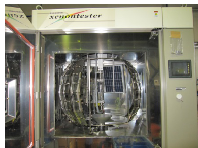
写真 太陽電池モジュールのキセノン ウェザーメーター試験機への取り付け例
