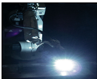
アーク溶接法
