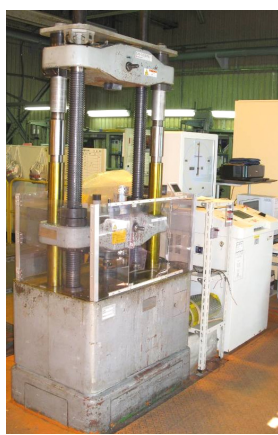
図3 500kN万能試験機 500kNまで RT～+100℃
