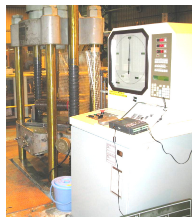
図4 2000kN万能試験機 2000kNまで RT～+100℃
