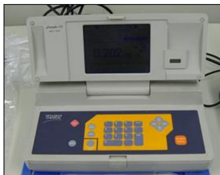
図2 4端子法抵抗測定装置 (三菱化学製 Loresta-GP, MCP-T600)
