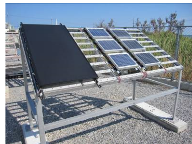
写真 太陽電池モジュール暴露試験サンプル (沖縄暴露試験場)
