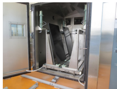
写真 大型太陽電池モジュールの複合 サイクル腐食試験機への取り付け例
