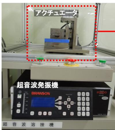
図1 超音波溶接機外観
