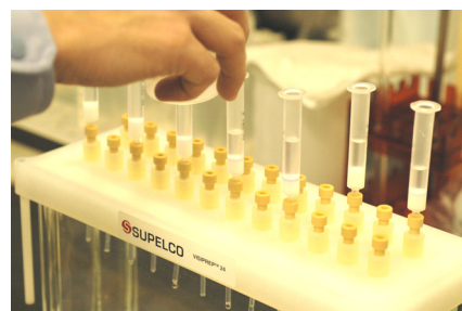
固相抽出カラムによる六価クロムの捕集・濃縮
