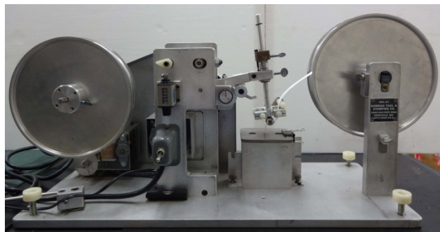
図1 Norman Tool, Inc製 RCA試験機外観
