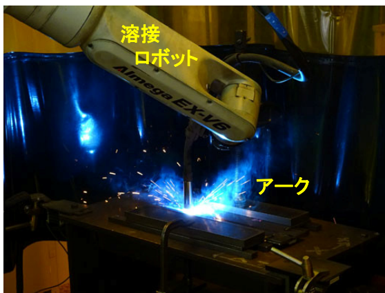
ロボットを用いたアーク溶接の状況
