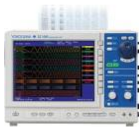
高速データ収集 (電流・電圧・速度・温度・・・)
