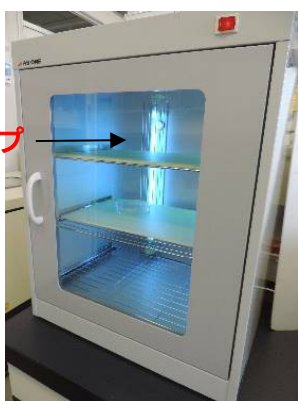
殺菌ランプを用いた「紫外線照射試験装置」
