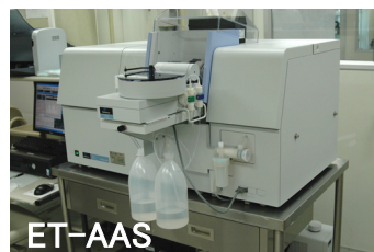
電気加熱原子吸光分析装置(ET-AAS)
