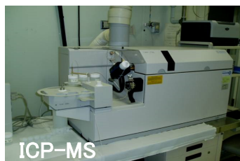
ICP質量分析装置(ICP-MS)
