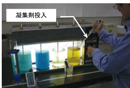
図1 ジャーテスター試験装置(重金属処理例)
