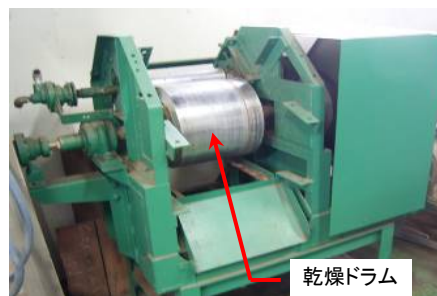
図10 ドラム式乾燥法試験装置(高濃度炭酸Na溶液処理例)
