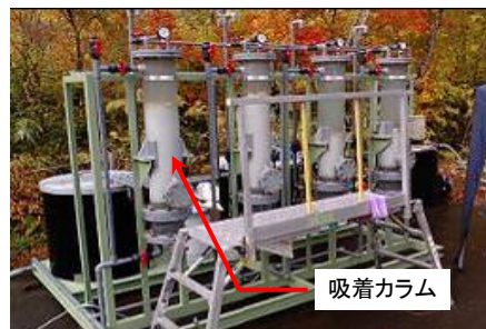
図8 固定床カラム試験装置(地下水処理例)
