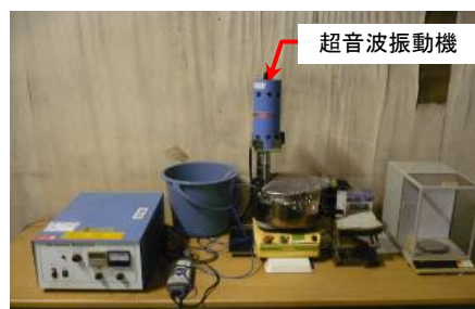
図12 振動式キャビテーション試験装置(金属材料評価例)
