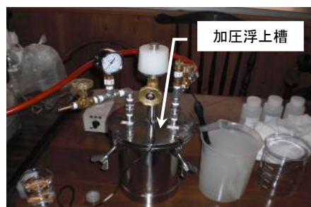
図4 加圧浮上試験装置(含油排水処理例)
