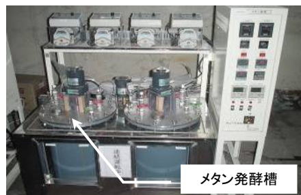
図6 メタン発酵試験装置(有機性排水処理例)
