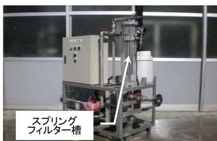
図5 スプリングフィルター試験装置(温泉水処理例)
