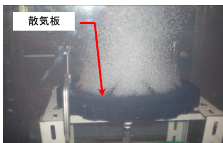
図11 散気板試験装置(水道水中の散気状況)
