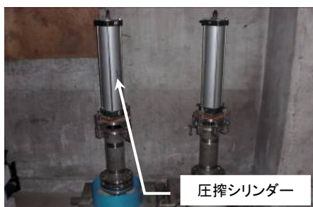
図3 シリンダー圧搾脱水試験装置(油泥脱水処理例)
