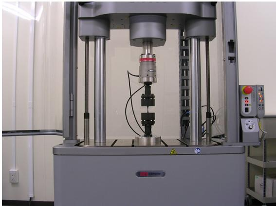
試験装置: Instron社製10kN疲労試験機
