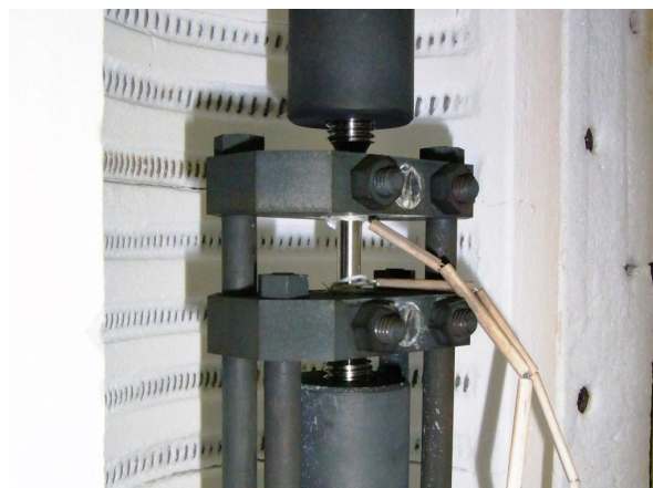
写真3 伸び計取り付け状況
