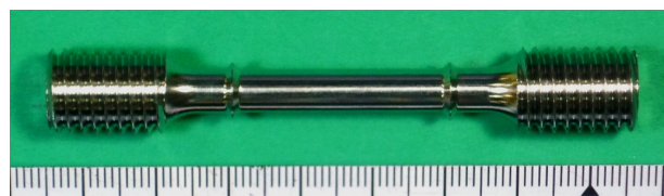
写真2 JIS G 0567 II-6型試験片 (φ6×GL30mm)
