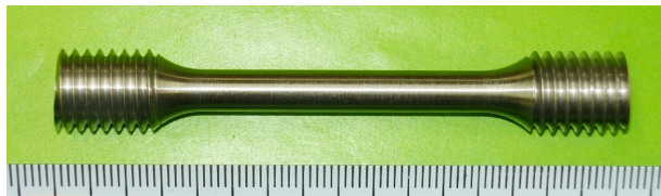
写真1 ASTM E8M Round Specimen (φ6×GL30mm) JIS G 0567 I-6型試験片 (φ6×GL30mm)
